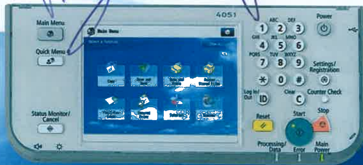
"Main Menu" (Menú Principal) Personalice la cantidad, el tamaño y el diseño de los botones de las funciones y seleccione un fondo.
